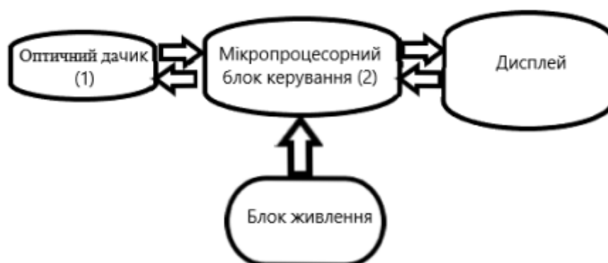
Рис. 3.1 – Структурна схема аналізатора змін периферійного кровотоку та динаміки трансформації молекул оксигемоглобіну.
