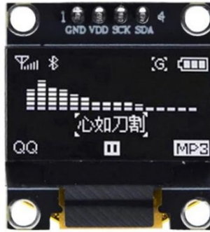
Рис 2.6 – Зовнішній вигляд дисплею OLED GME12864-52 [19]
