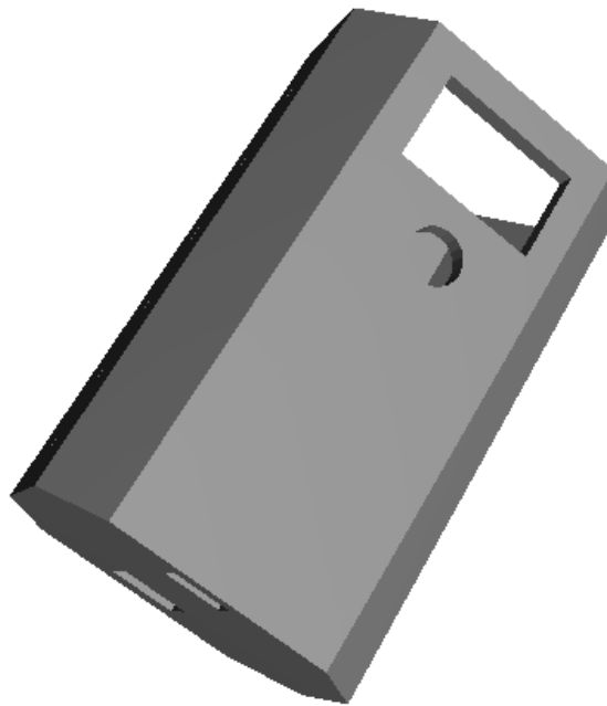
Рис 2.8 – Зовнішній вигляд макету корпусу, розробленого для друку на 3D принтері.
