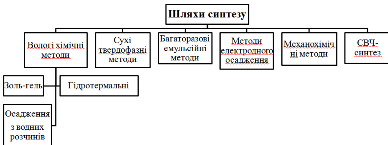
Рис. 1.2. Різні синтетичні шляхи отримання ГАП з різною морфологією, кристалічністю і стехіометрією.
