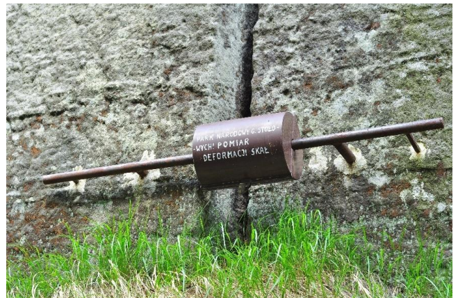
Рис. 5 – Самописець автоматично фіксує деформації схилу (фото С. Бортника)
