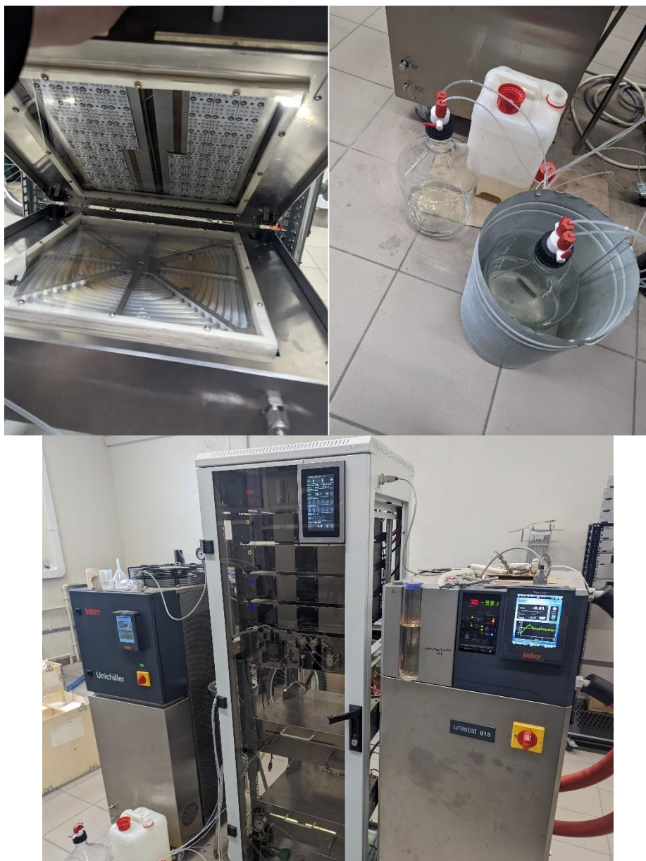
Рисунок 19. Фото великої установки. Зверху зліва спіраль реактора та масив LED, справа резервуари з вихідною сумішшю та продуктом. Знизу загальний план установки, зліва та справа холодильні установки Huber, в центрі стійка із реакторами, керуючим блоком та блоками живлення.
