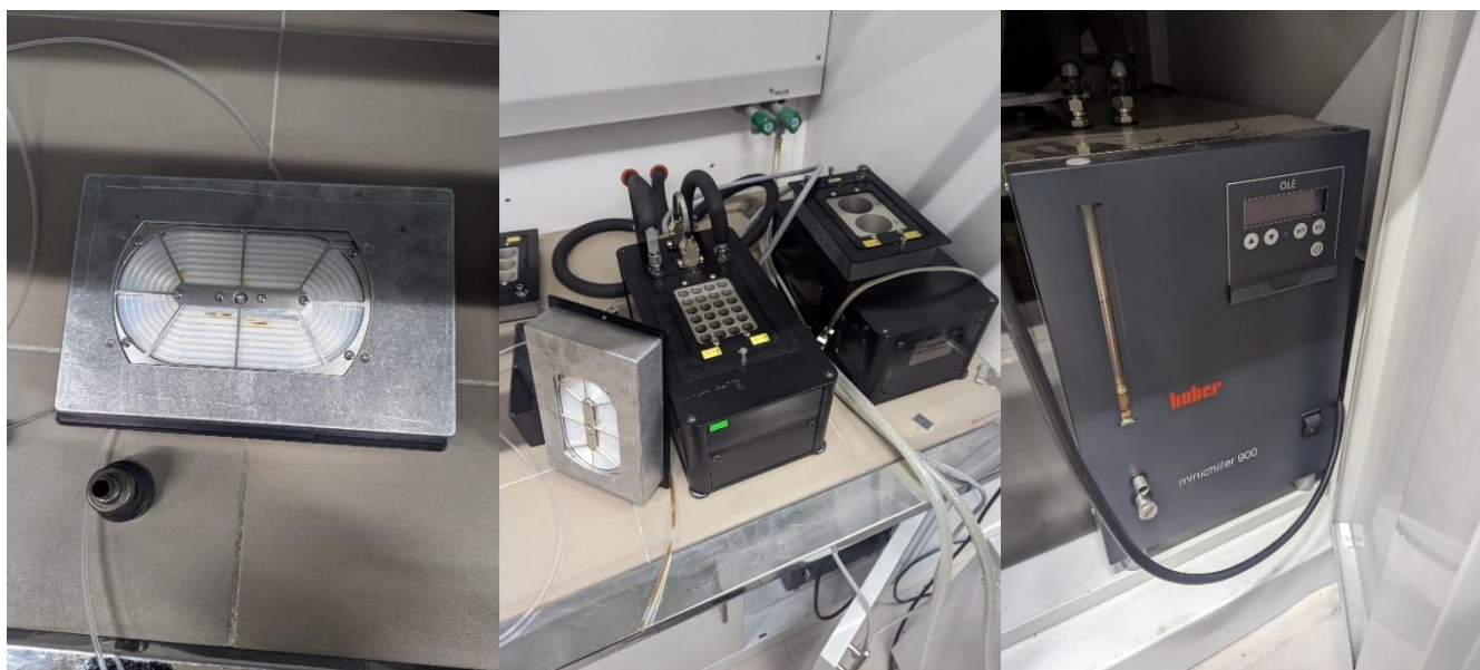
Рисунок 18. Фото малої установки. Зліва спіраль фото реактора, по центру блок опромінення, блок керування із іншим видом тримача, справа холодильна установка.
