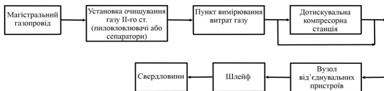
Рис. 1. Принципова технологічна схема руху газу під час закачування в ПСГ
