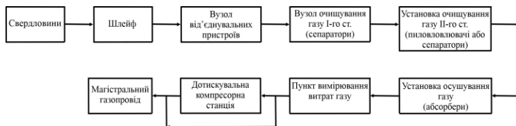
Рис. 2. Принципова технологічна схема руху газу під час відбирання з ПСГ
