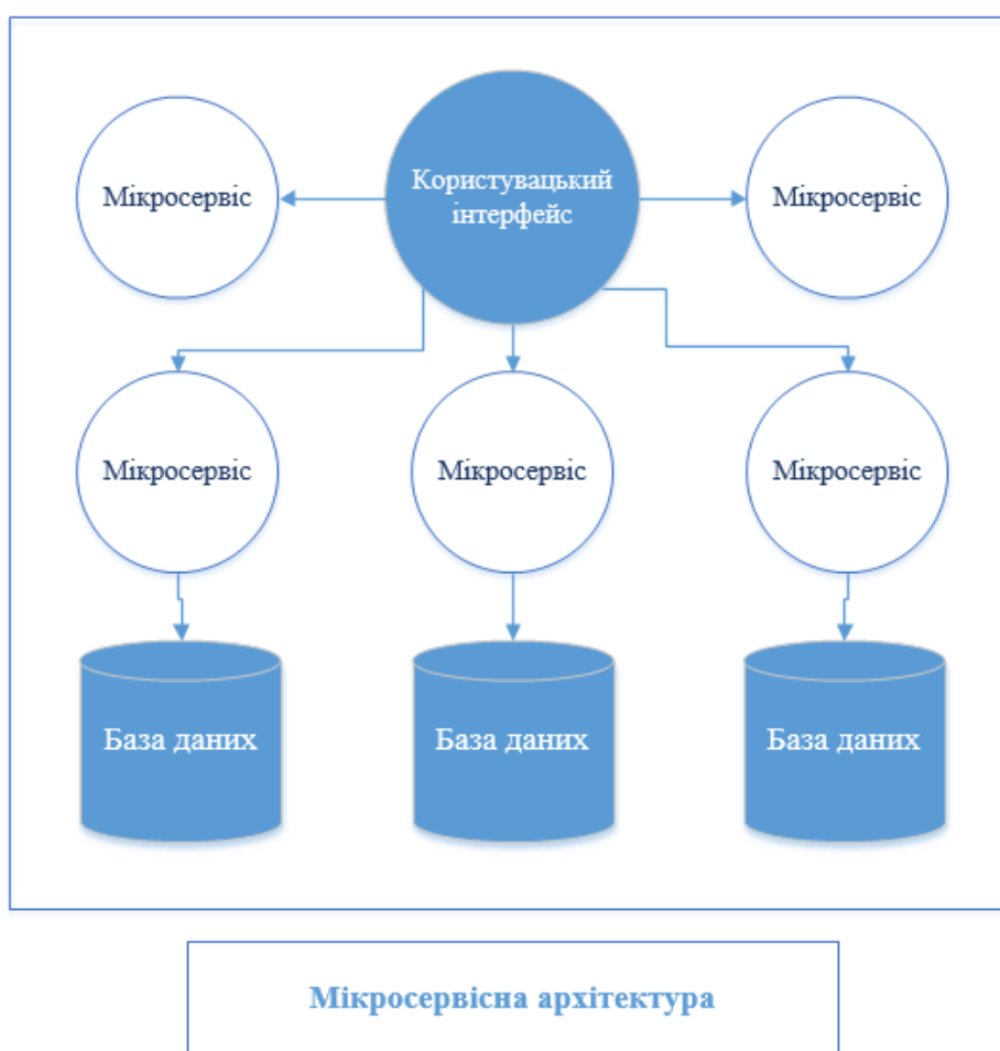
Рисунок 1.1 – Схематичний приклад роботи мікросервісної архітектури
