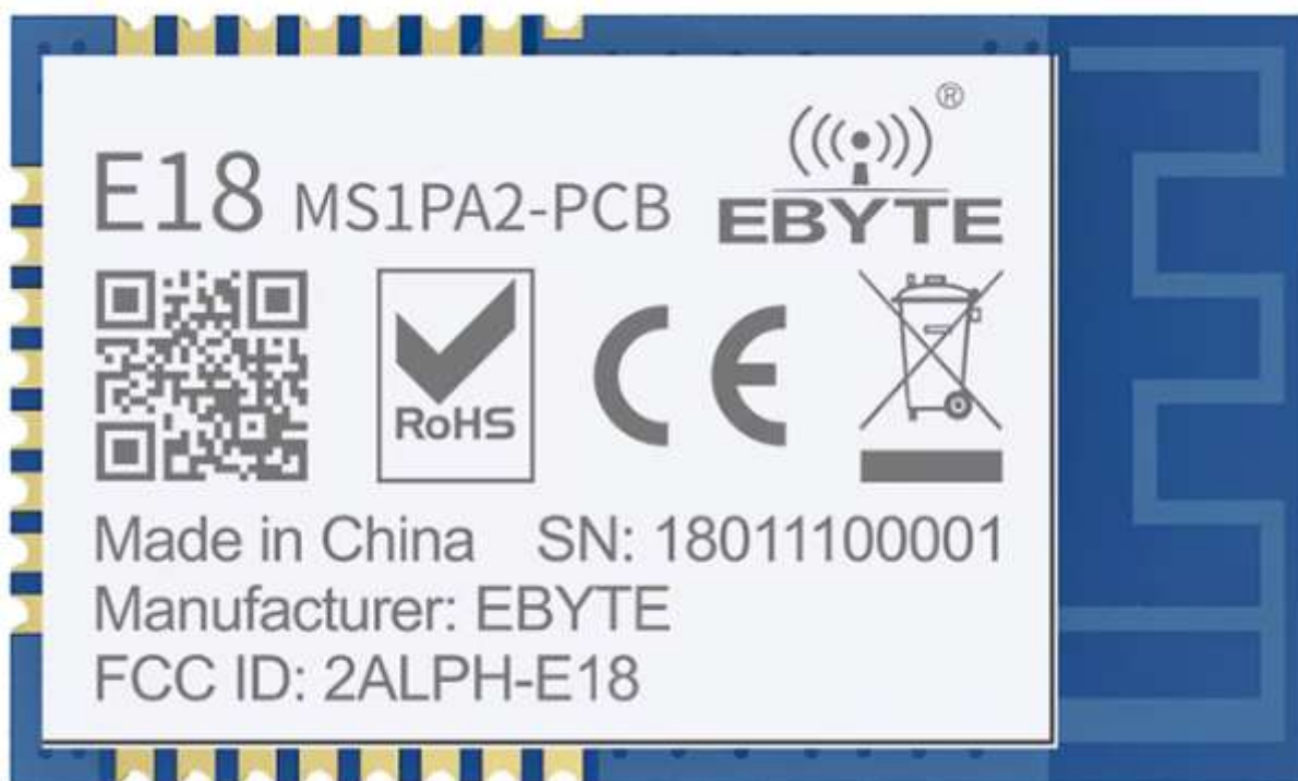
Рисунок 2.3 – Чіп cc2530 для роботи в мережі ZigBee
