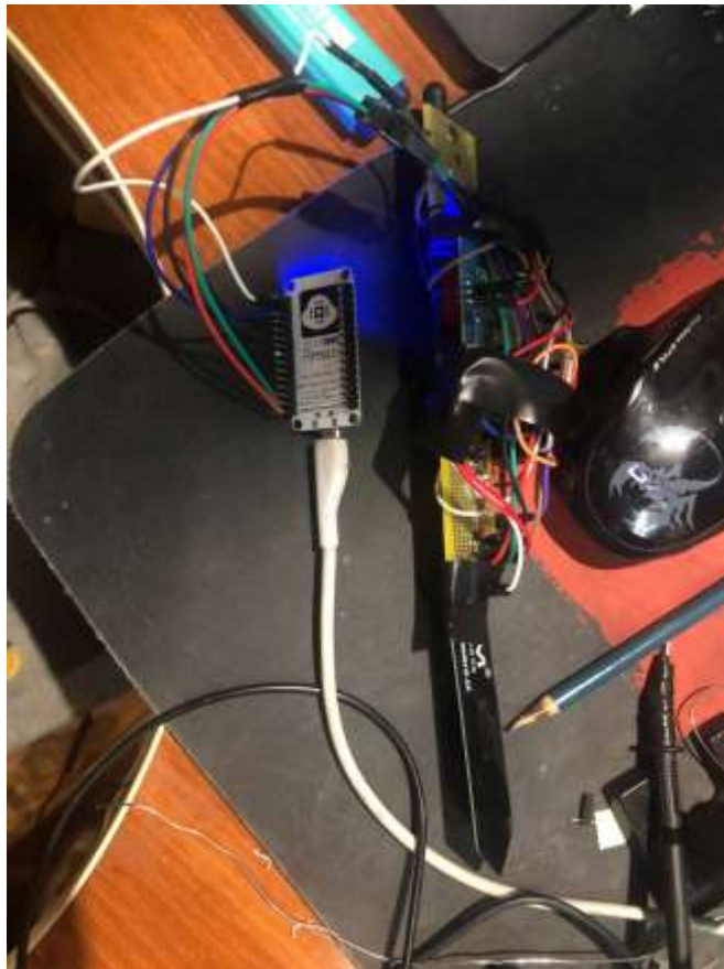
Рисунок 2.12 – підключення готового пристрою для його подальшої прошивки
