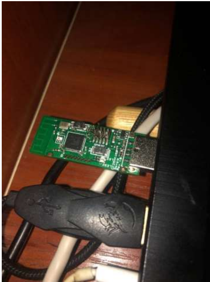
Рисунок 3.1 – USB ZigBee стік для старту роботи мережі
