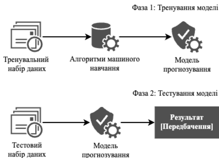
Рис. 3.2. Концептуальна схема проєктування нейромережеских моделей на основі алгоритмів машинного навчання.
