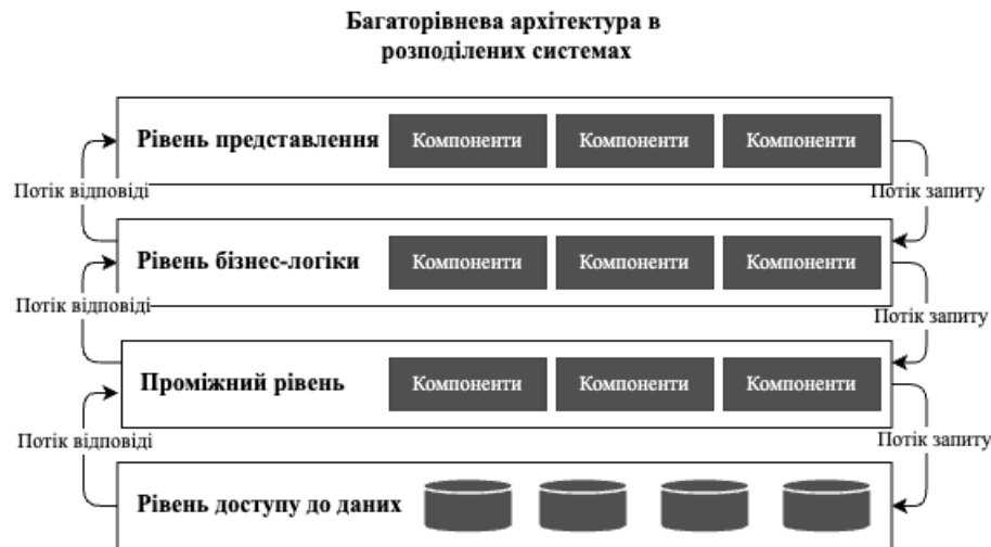
Рис. 1.3. Багаторівнева (Layered) архітектура в розподілених системах.
