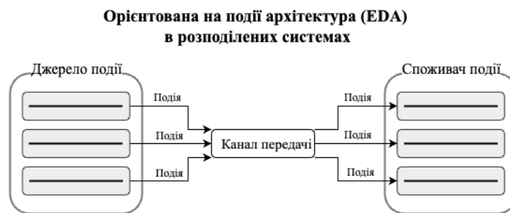
Рис. 1.6. Архітектура, орієнтована на події (Event-Driven Architecture, EDA) в розподілених системах.
