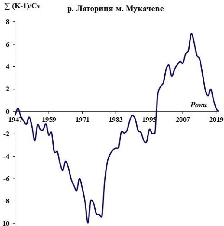
Рис. 1.9. Різницева інтегральна крива середньорічного стоку води на гідрологічному посту р. Латориця м. Мукачеве за період 1947 – 2020 рр.
