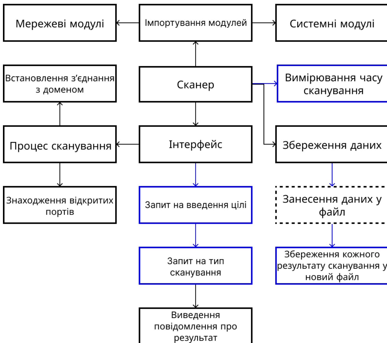
Рисунок. 3.14. Структурно-логічна схема сканеру з покращеннями.
