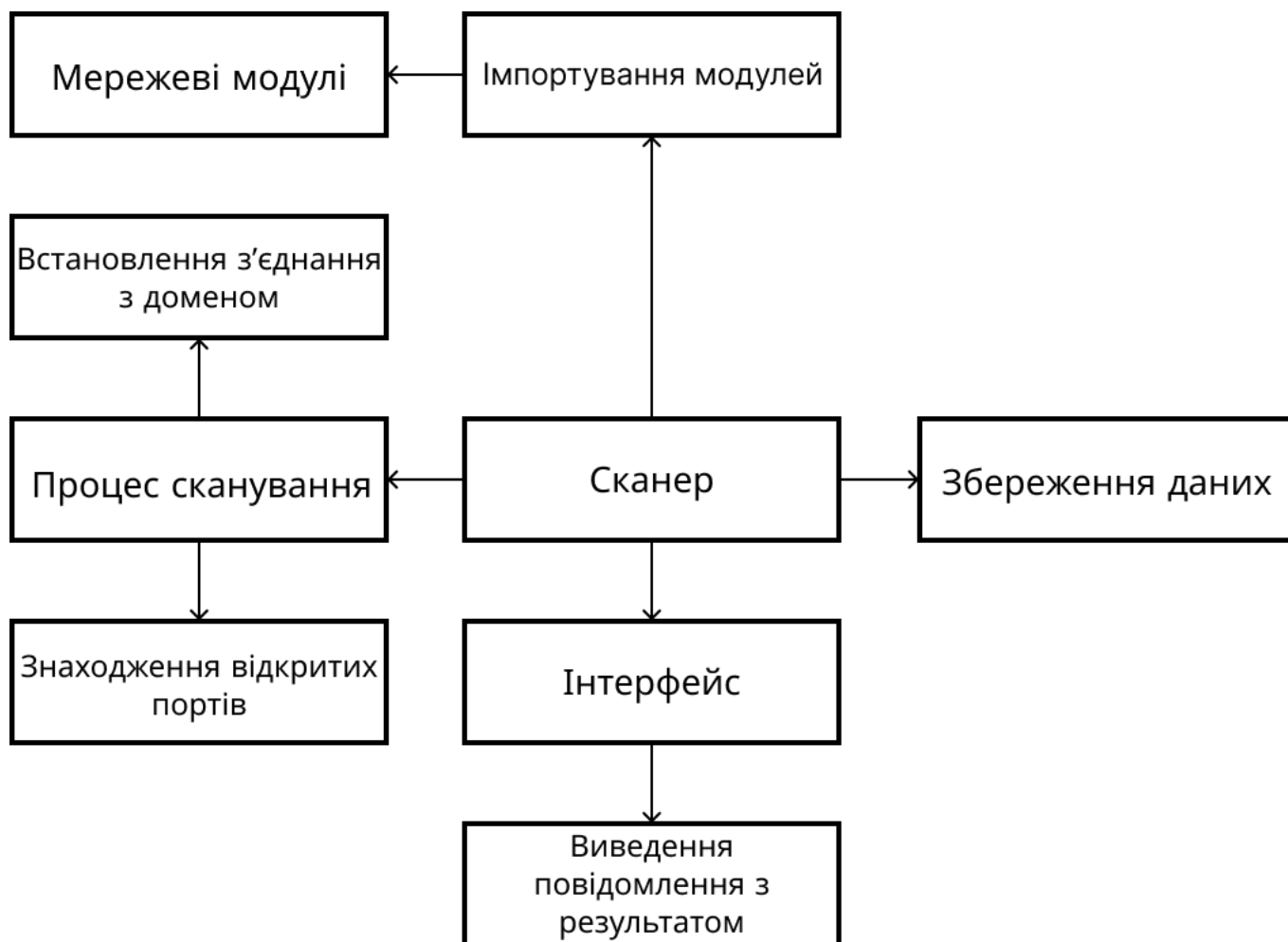
Рисунок.3.1. Структурно-логічна схема найпростішого сканера.
