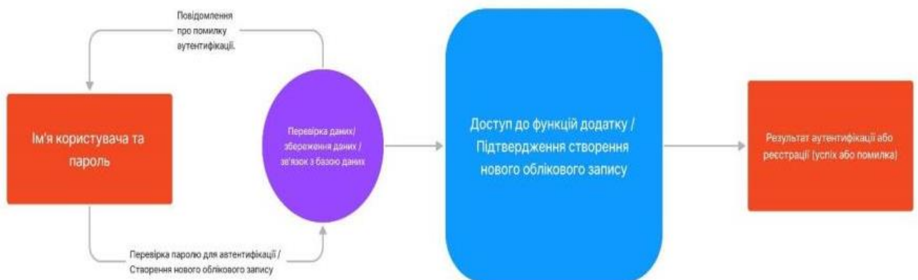
Рис. 3.15. Діаграма потоку даних для автентифікації та реєстрації користувача
