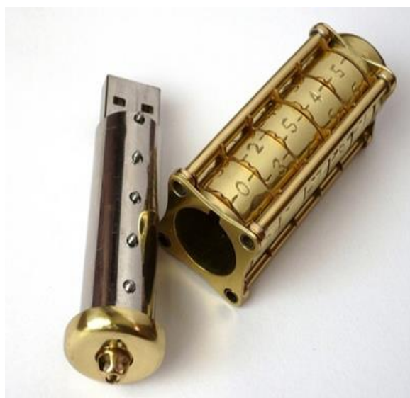
Рисунок 3.2 – Криптекс для приховування флешки
