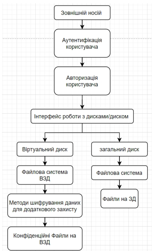
Рисунок 4.2 – Логічна структура алгоритму роботи зовнішнього носія з ВЗД
