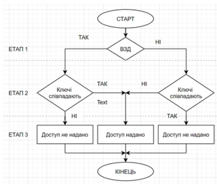
Рисунок 4.4 – Алгоритм визначення надання прав доступу на запис до розділу на накопичувачі інформації з ВЗД.
