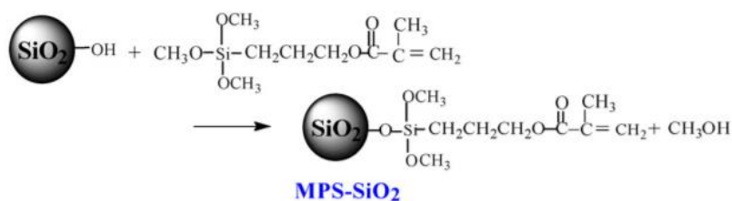
Рис. 13 Схематична ілюстрація процесу приготування композиційних частинок ПАО / SiO 2 .
