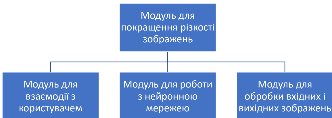
Рис 2.1. Схема архітектури програмного модуля покращення зображень
