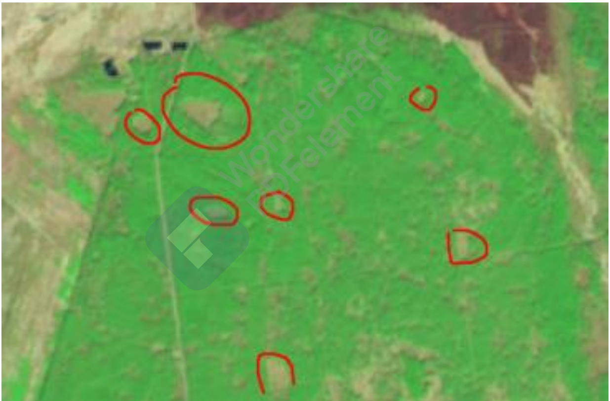
рис. 4.1 Дешифрування вирубок (місця вирубок, які виділяються як світлі плями)
