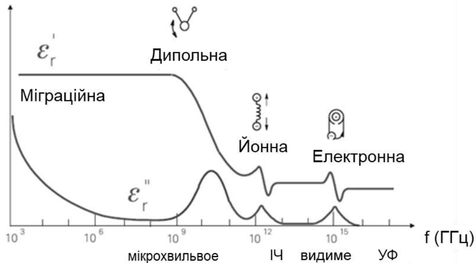
Рис. 1.2. Спектр діелектричної проникності у широкому частотному діапазоні. Різні механізми релаксації позначені на тих частотах, на яких вони реалізуються. 17
