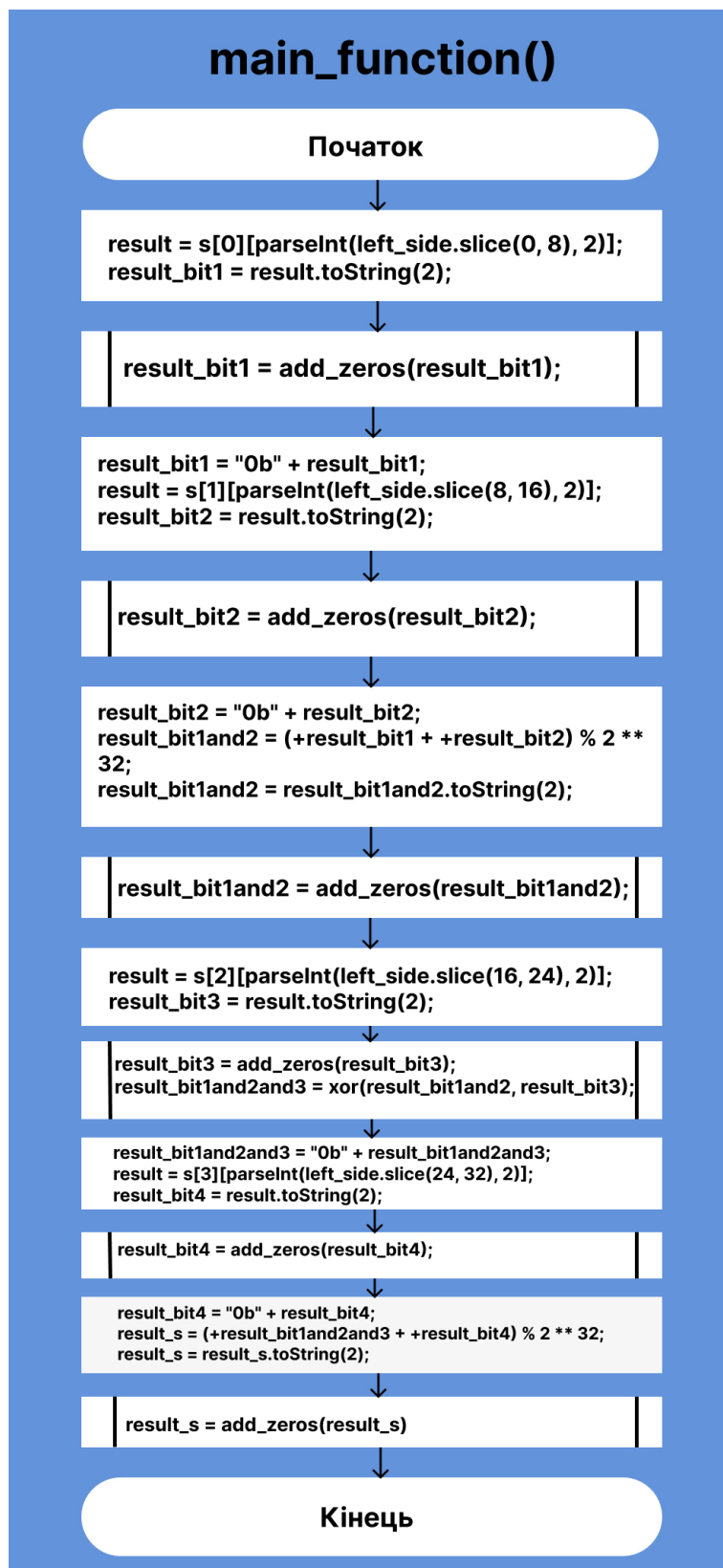
Рисунок 3.16 – Блок-схема раундової функції алгоритму Blowfish
