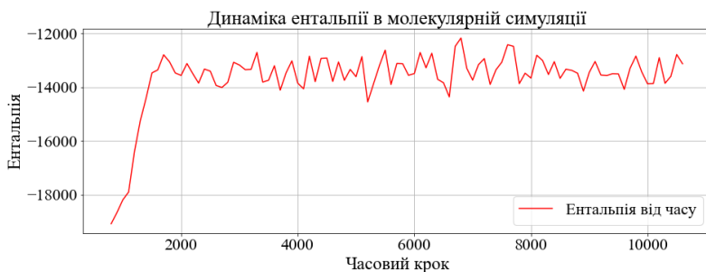
Рис. 17: Еволюція ентальпії системи ПЕГ у воді протягом часу симуляції.
