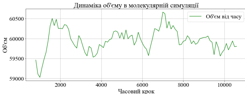
Рис. 16: Зміна об'єму системи ПЕГ у воді в ході симуляції.
