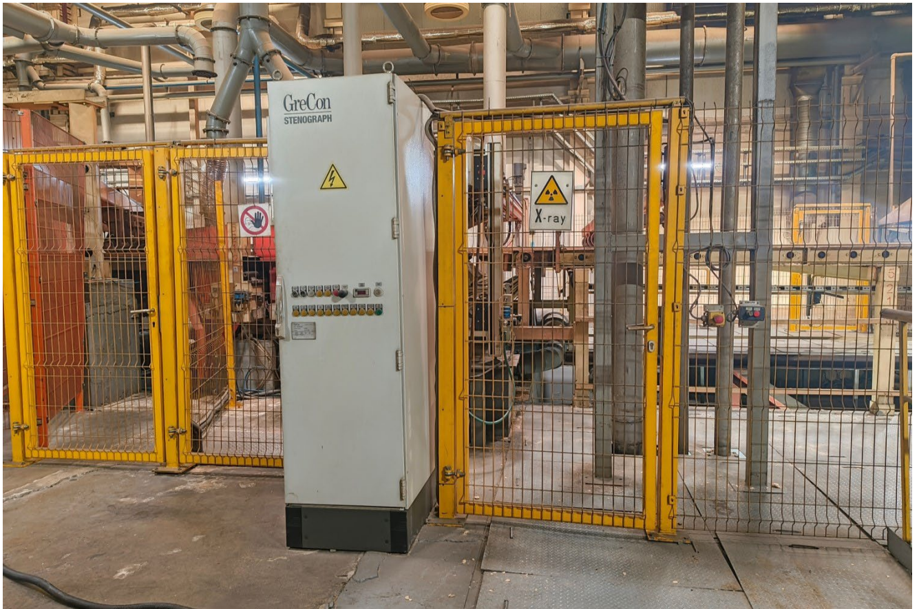
Світлина 1 та 2. Установка GreCon STENOGRAPH для вимірювання профілю густини сировини безпосередньо в потоку
