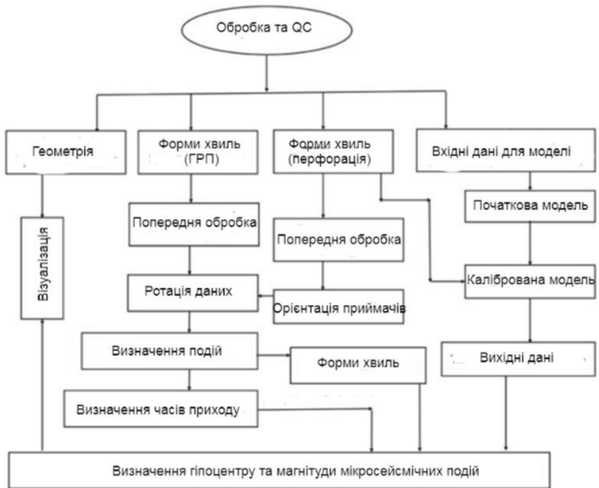
Рисунок 1.9. Процес обробки свердловинних мікросейсмічних даних (модифіковано за Akram, 2020)
