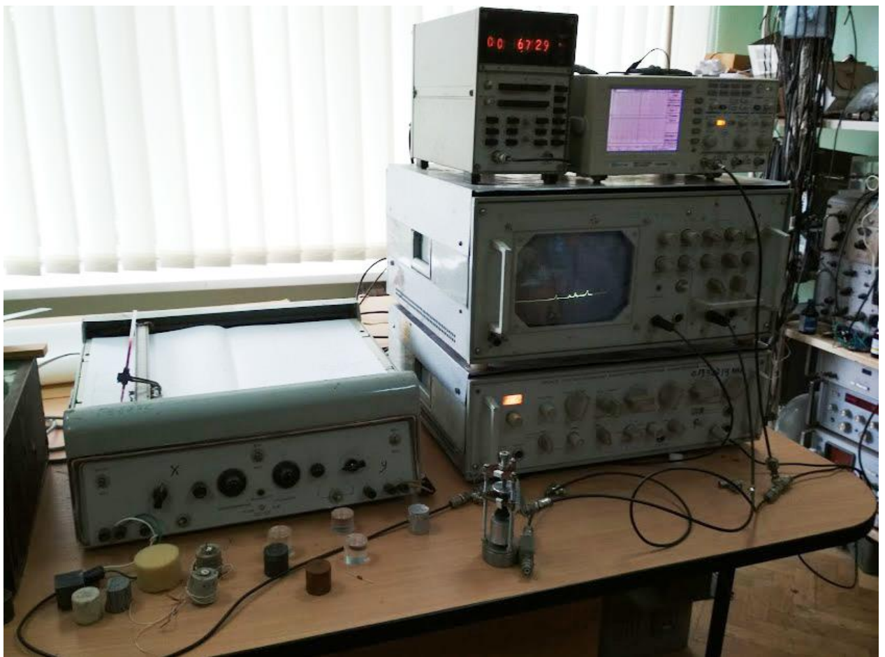
Рисунок 1.5. Комплекс вимірювального обладнання для визначення пружних модулів гірських порід резонансним методом
