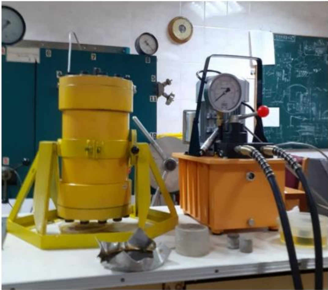
Рисунок 1.6. Установка для вивчення поведінки гірських порід під час ГРП.
