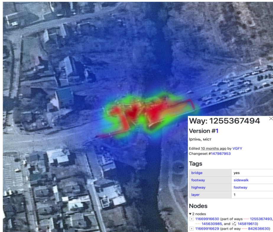
Рис. 2.9 Пошкоджений міст в м. Ірпінь локалізований за допомогою Grad-CAM heatmap та його онтологія OSM
