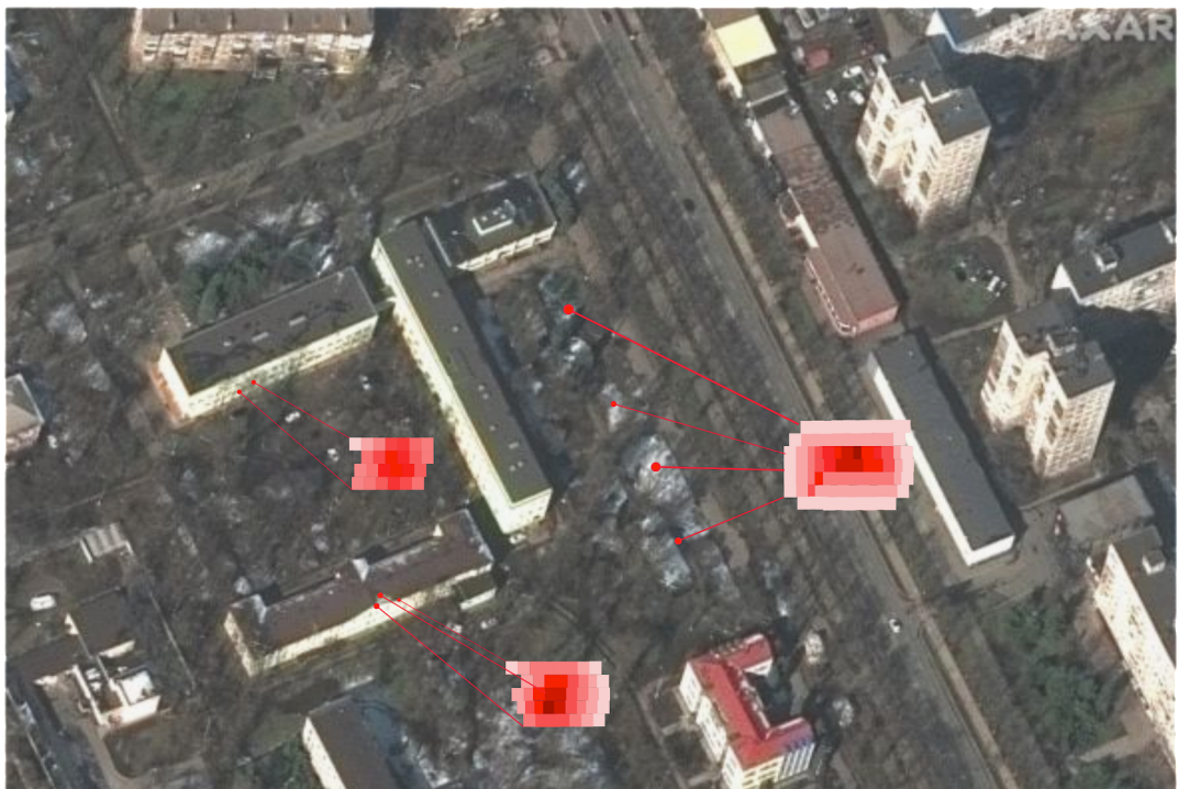
Рис. 1.3 HSR знімок МАХАР. Комплекс будівель міської лікарні в м. Маріуполь, демонструє різноманітність пошкоджень через глобальну сцену і локалізацією до рівня компонентних ознак з картами інтенсивності пошкоджень
