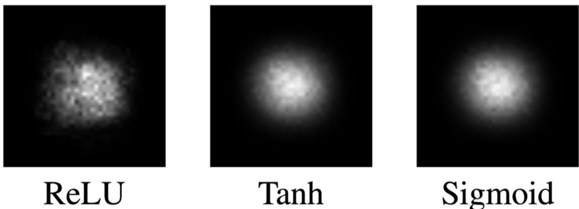
Рис. 1.8 Порівняння впливу нелінійних активацій (ReLU, Tanh та Sigmoid) на ERF. ReLU робить розподіл менш гауссовим. Виходи ReLU точно нульові для половини своїх входів. Таким чином, легко отримати нульовий вихід для центрального пікселя на вихідній площині
