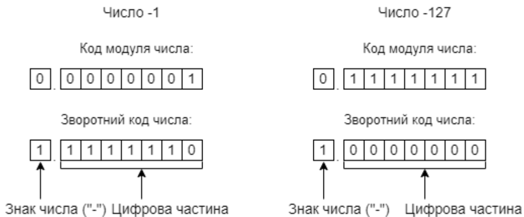
Рисунок 1.2 – Представлення від'ємного числа у зворотному кодi
