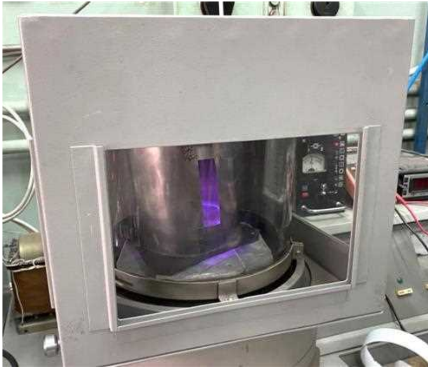
Рис. 5. Генерація плазмового радіочастотного розряду
