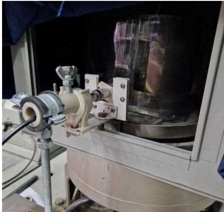
Рис. 6. Підключення спектрометра до джерела світлового випромінювання
