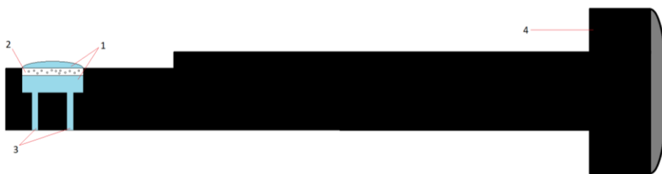
Рисунок 6: 1 – агарозний гель, 2 – зразок, 3 – отвори в тримачі зроблені для кращого закріплення гелю, 4 – зачіпка за механічний переміщувач
