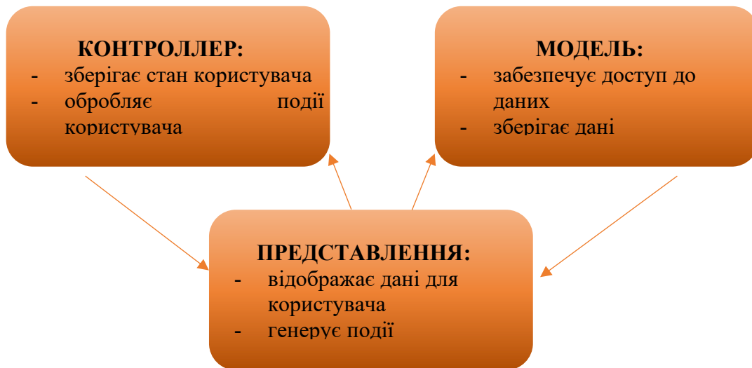
Рисунок 3.1 - Прикладна схема архітектури MVC
