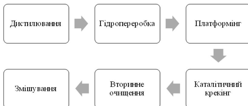
Рис.3.6. Основні етапи виробництва нафтопереробного підприємства групи компаній «Шелл»
