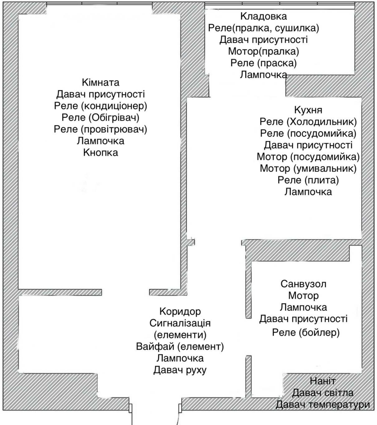
Рис. Б1.1 розміщення приладів у квартирі. У коридорі у нас встановлено сигналізацію в яку входить кнопка, п'єзоелемент, давач руху, який
