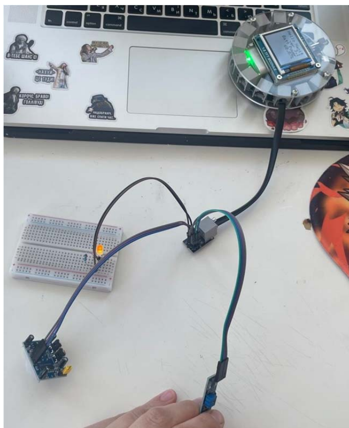
Рис. 5.21 робота частини моделі під пункт сімнадцять та двадцять. Тобто загорання лампочки, при присутності та відсутності світла навколо.
