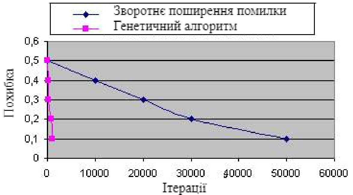
Рисунок 3.8 – Порівняльна характеристика функцій помилки при різних алгоритмах навчання нейронної мережі
