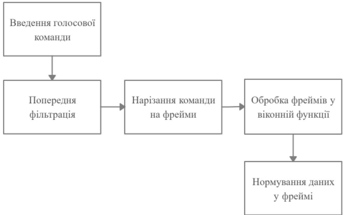
Рисунок 3.1 – Схема алгоритму попередньої обробки голосових команд Докладніше про кожну частину обробки вхідної інформації.
