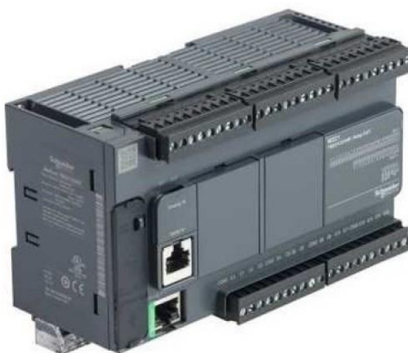
Рисунок 2.7 – контролер Schneider Electric
