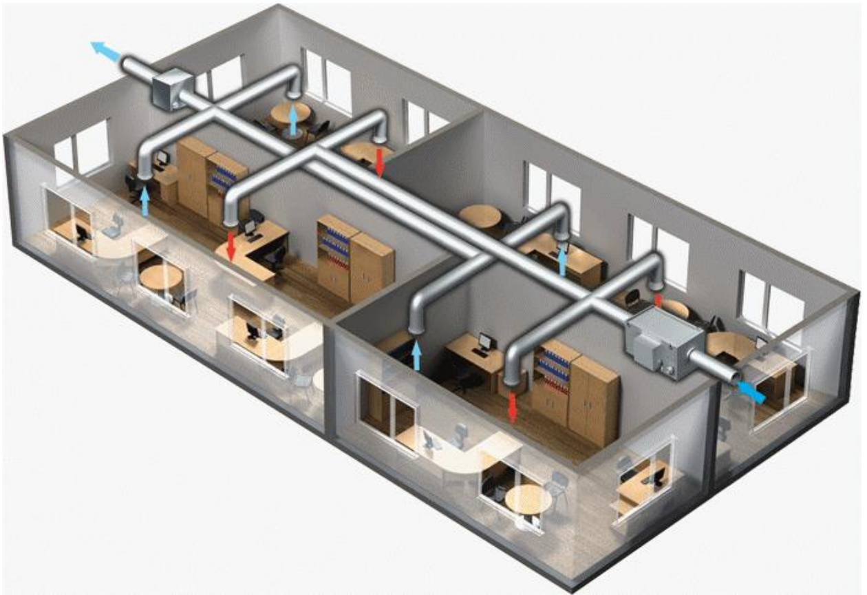
Рисунок 1.5 – система вентиляцій в офісах
