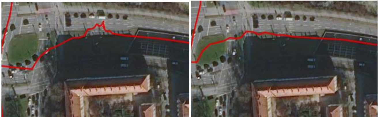
Рисунок 19 – Траєкторія під час в'їзду у тунель. Траєкторія, отримана з фільтру (справа) є набагато плавнішою і набагато ближча до справжньої, ніж отримана з GPS (зліва)
