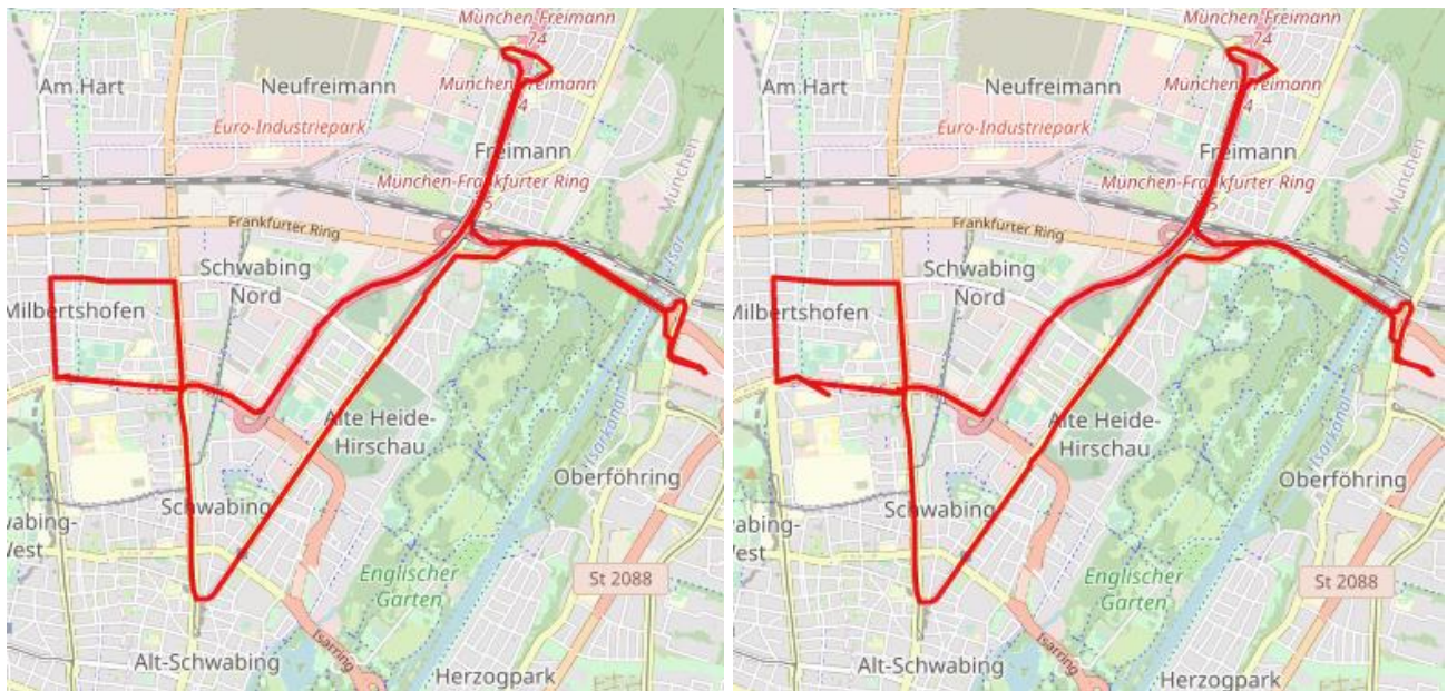
Рисунок 18 – траєкторія за даними GPS (зліва) та за фільтром з моделлю CTRV (справа)
