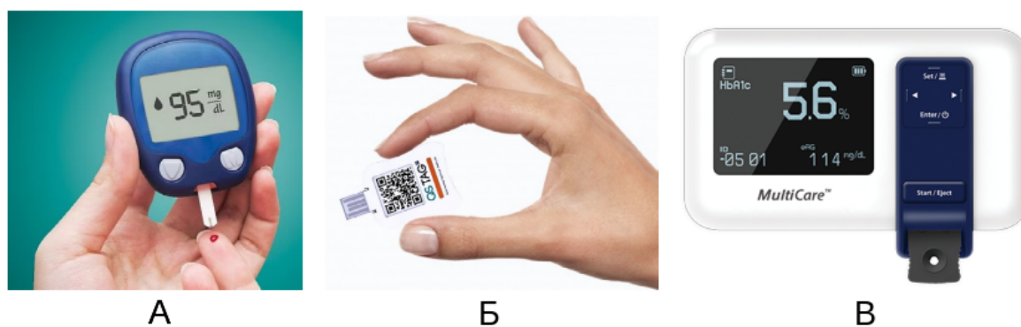
Рис. 1.2. Більшість медично застосовних сенсорів одноразового використання: А. глюкометр з паперовими полосками (взято з [21]), Б. COVID-19 сенсор (взято з [22]), В. імунохімічний мульти-сенсор з тест-полосками (взято з [23]).
