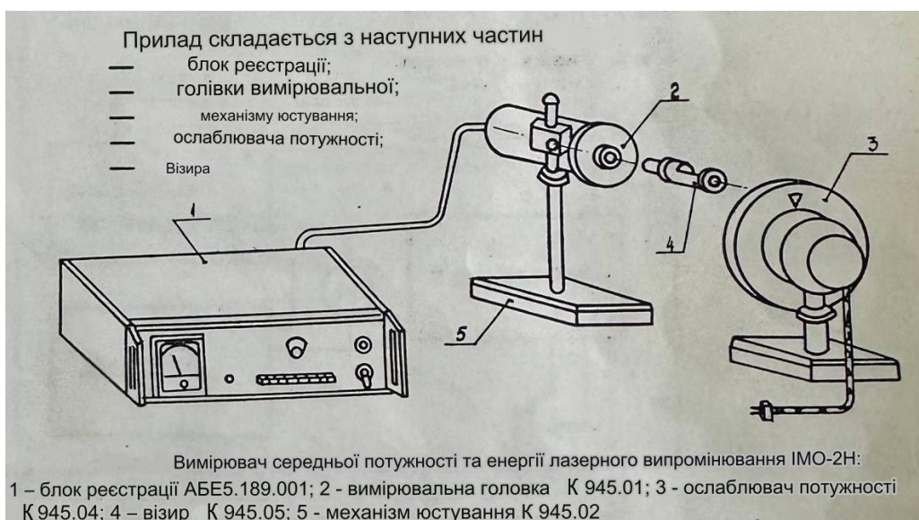
Рис. 2.6 Схематичне зображення ІМО-2Н та його складові
