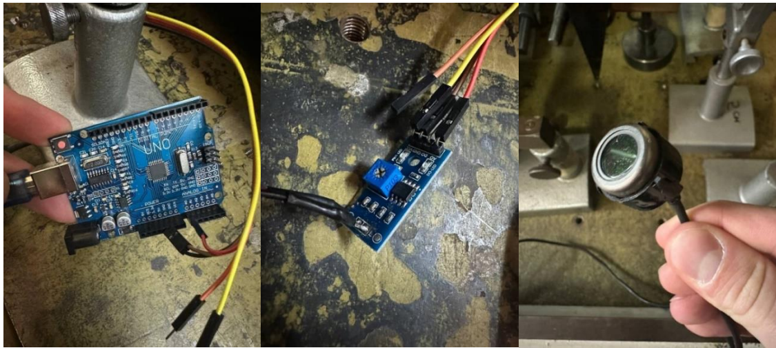
Рис. 2.15 Зображення схеми плати Arduino UNO з фотодіодом на підсилювачі LM393 для реєстрації інтенсивності світла.
