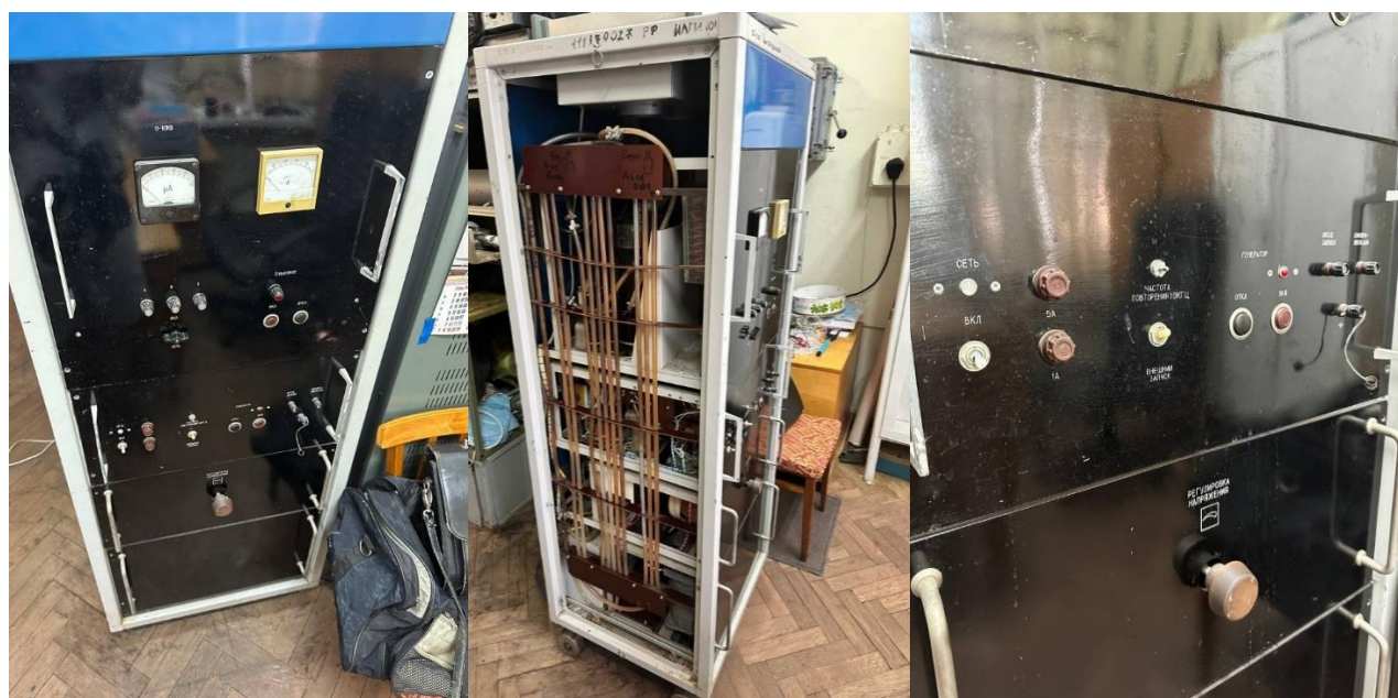
Рис. 2.4 Зображення модернізованого джерела живлення ІІ-18
