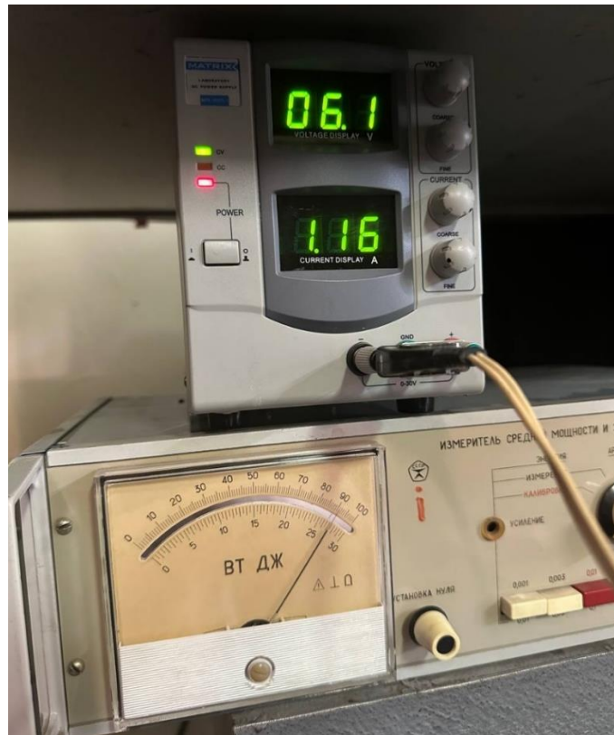
Рис. 2.9 Залежність потужності синього лазера від напруги живлення, яка досліджувалася за допомогою ІМО-2Н
