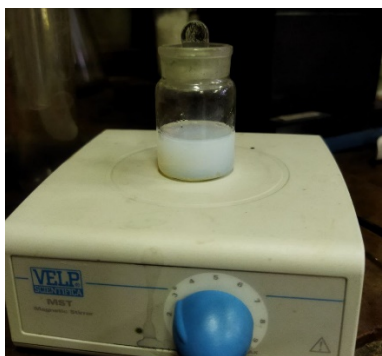
Рис.3.3. Суміш ПС@ПНІПАМ-ПАА з ЕДОТ та SDS на магнітній мішалці.
