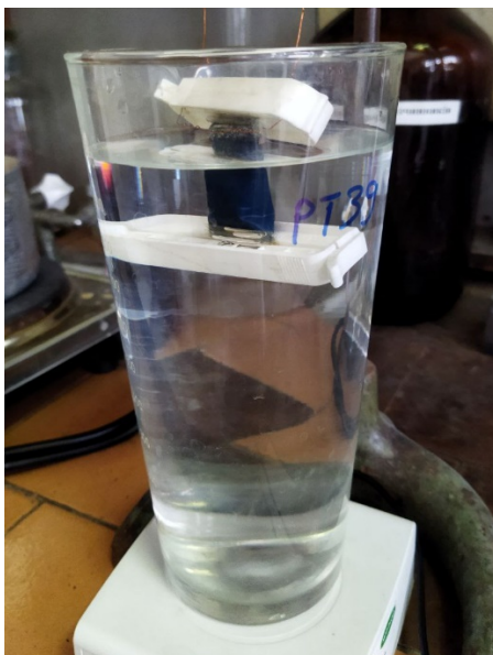
Рис. 3.8. Діаліз зразка РТ39.
