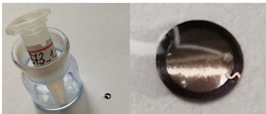
Рис. 3.13. Підготовка зразка для ТЕМ: підкладка з нанесеною на неї водною дисперсією ПС@ПНІПАМ-ПАА
