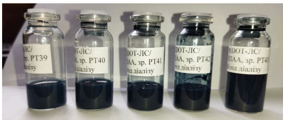
Рис. 3.9. Зразки дисперсій РТ39-43 ПС@ПНІПАМ-ПАА/ПЕДОТ у воді після діалізу 48 год.
