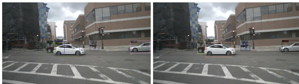
Рисунок 3.11 – Приклади розпізнавання автомобілів за допомогою моделі Faster R-CNN, доопрацьованої на двох наборах даних
