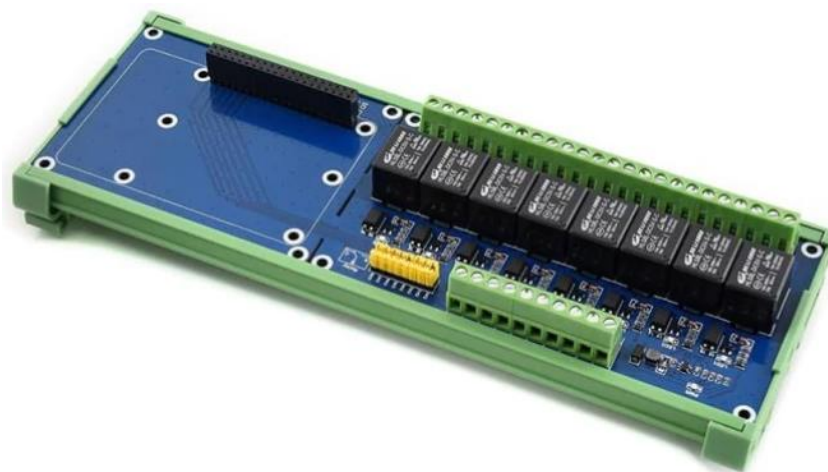
Рисунок 2.2. 8-канальна плата розширення реле для Raspberry Pi
