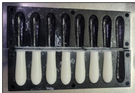
Рис 2.10 Супозиторії, що містять фаголізат, після застигання
