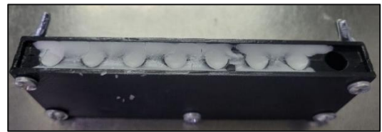
Рис 2.9 Форма для супозиторіїв після застигання жиру
