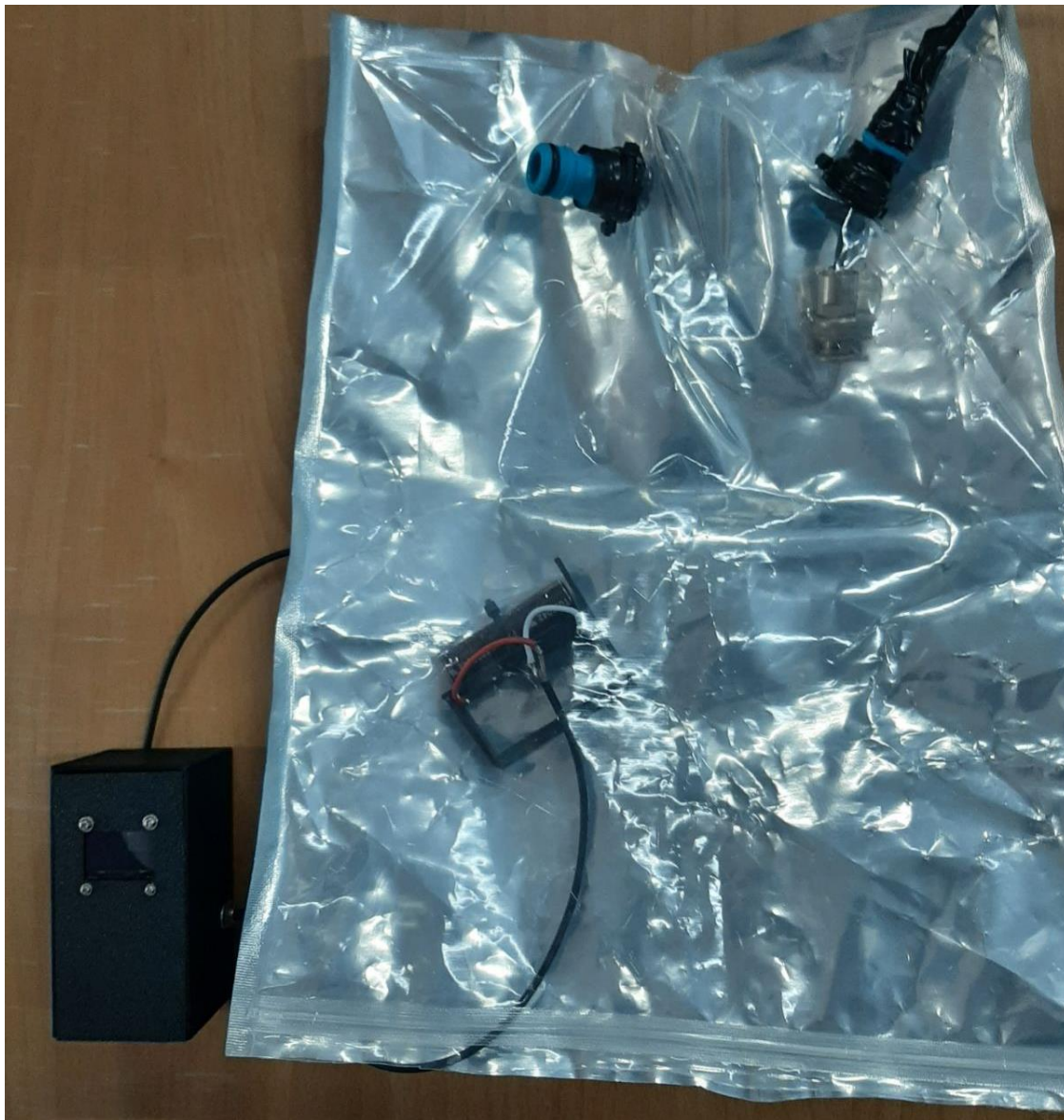
Рис. 2.11. Фото системи збирання видиху - прозорий мішок із силікагелем між мундштуком і пристроєм.
