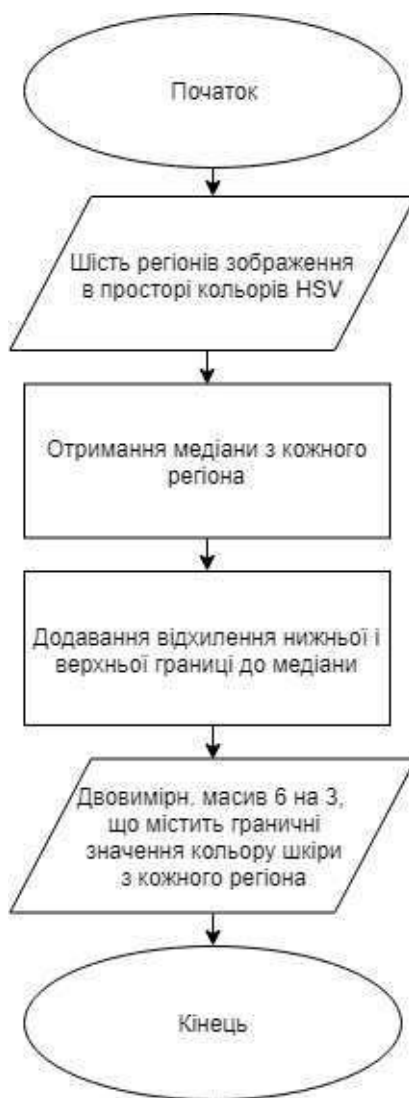
Рисунок 3.7 - Блок-схема алгоритму знаходження граничних значень кольору шкіри
