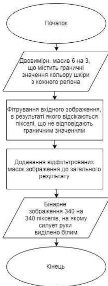
Рисунок 3.8 - Блок-схема алгоритму створення бінарного зображення силуету руки
