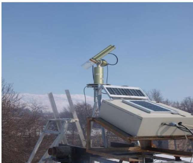
Рис. 1.4. Вигляд установки сонячного фотометра Citel CE-318 групи моніторингового забезпечення (станція спостереження у м. Душанбе, Таджикистан)
