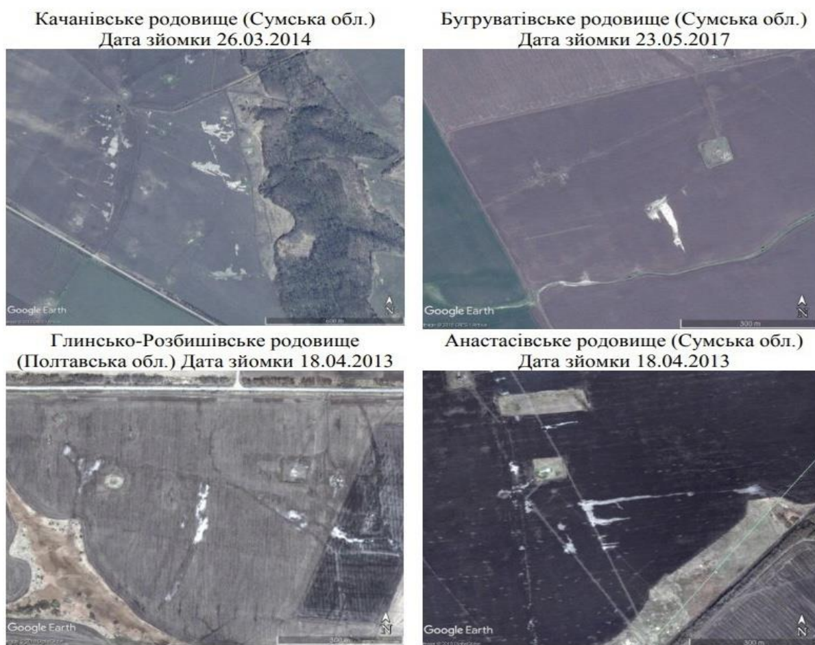
Рис. 3.1 – Ділянки засолених ґрунтів унаслідок витоків СПВ із водоводів на родовищах Східного НГ басейну
