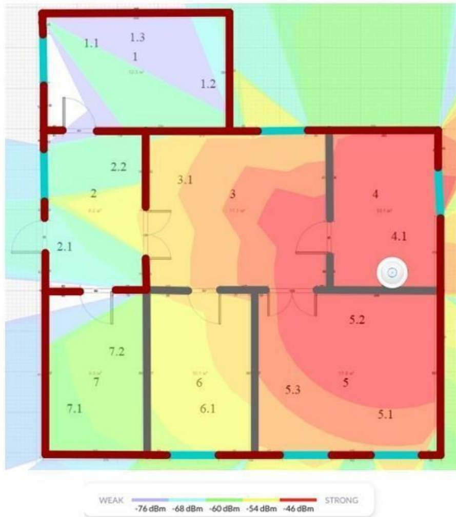
Рис.5. Карта покриття Wi-Fi будівлі з сьома кімнатами при 2.4 ГГц
