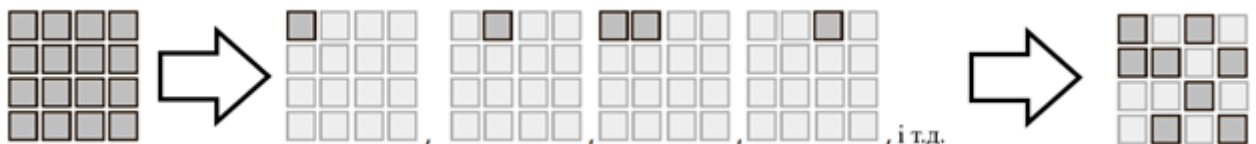
Рисунок 1.7 – Схема роботи алгоритму повного перебору.
