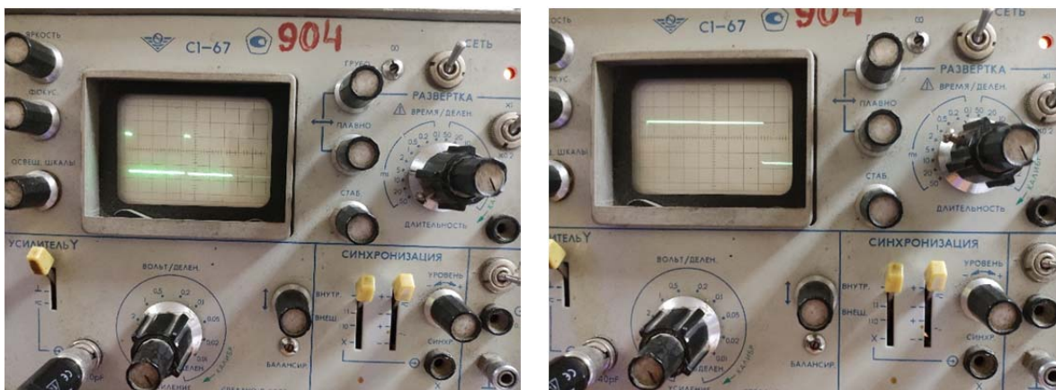
Рисунок 4.4 осцилограми PWM сигналу для керування сервоприводом або ESC.
