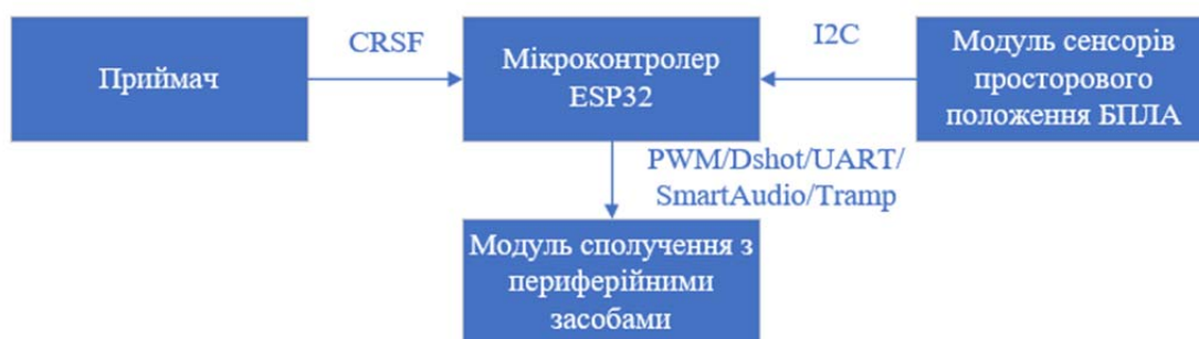
Рисунок 2.1 Структурна схема польотного контролеру
