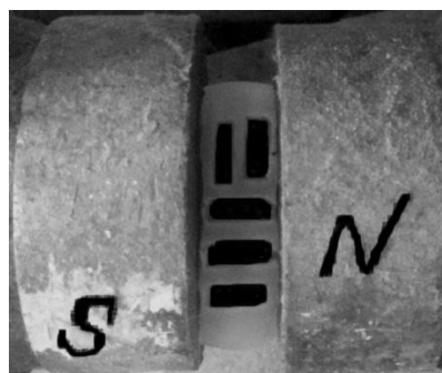
Рис. 2.4. Силіконова форма з композитом, розміщена між полюсами постійного магніту.
