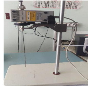
Рис. Г.3.1. – Фотографії векторного аналізатора мереж KeysightNetworkAnalyzerN5227A з сенсором AgilentDielectricProbe: (а) основний блок, (б) штук для вимірювання \varepsilon' , \varepsilon'' .
