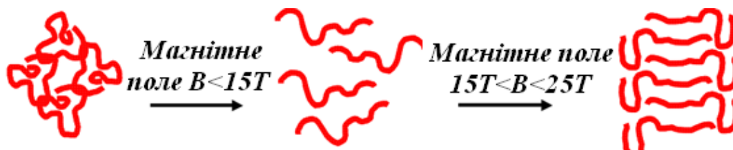
Рис. 1.10. Схематична ілюстрація впливу магнітного поля на ВНТ [82].
