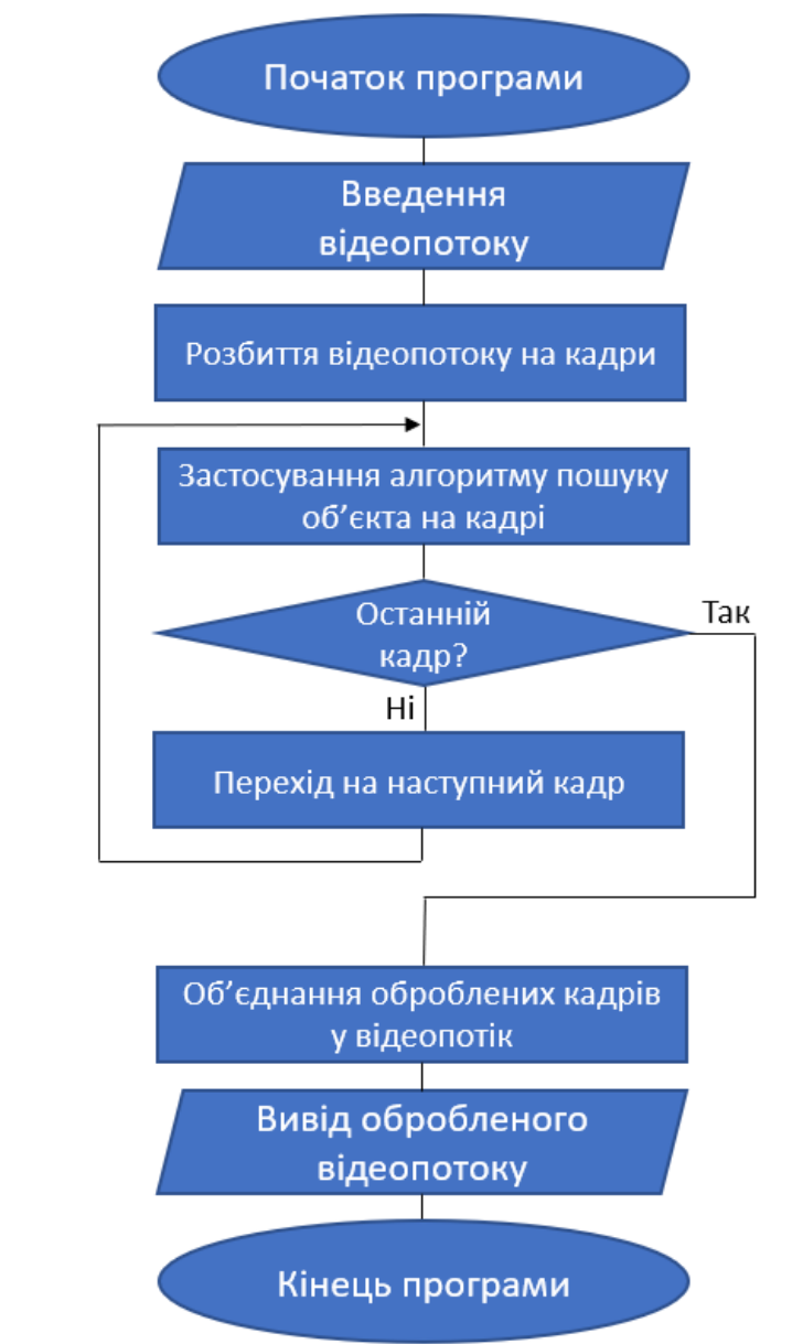
Рисунок 4.10 - Блок-схема роботи програми для пошуку об'єктів на відеопотоці.
