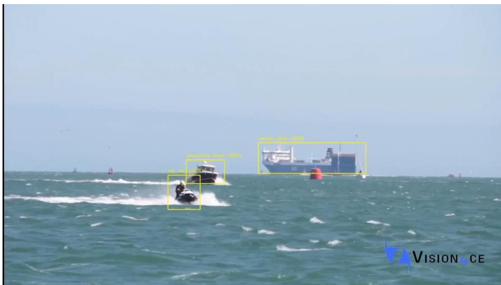
Рисунок 3.2 – Приклад відстежування об'єкту за допомогою Vision4ce.
