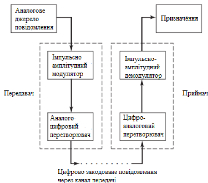
Рис 1.9 Блок-схема системи ІКМ (імпульсно-кодова модуляція)[5].
