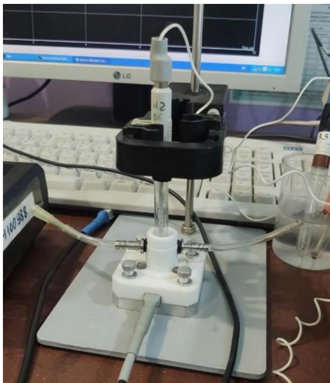
Рисунок 11. Приєднаний ІСПТ-електрод в кюветі з аналітичним розчином до характеріографа та з зануреним хлорсрібним електродом порівняння.
