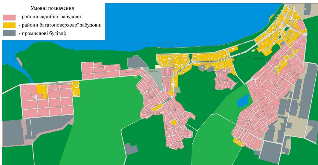
Рис. 2.1. Схема функціонального зонування житлової та промислової забудови м. Світловодськ [20]
