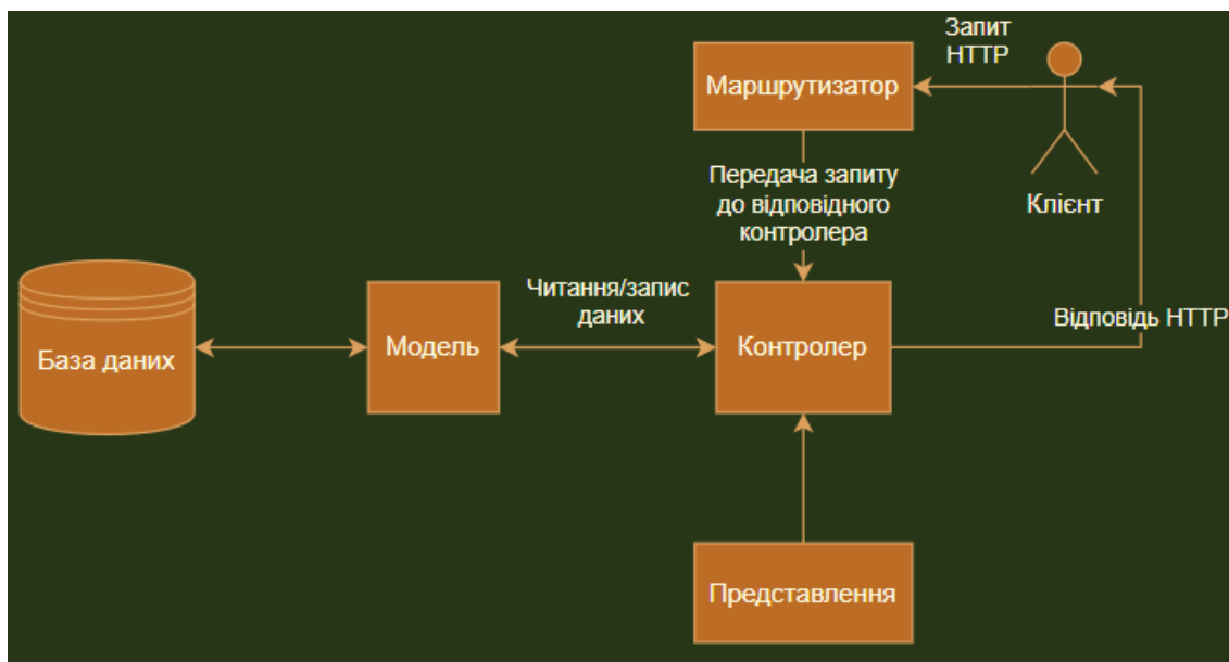
Рисунок 3.3. – Спрощена схема роботи патерну MVC
