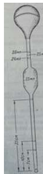
Рис. 1.1. Схема установки для визначення механічного складу ґрунту методом піпетки (за Качинським) [14] А – піпетка, градуйована на 24-26 см 3 ; Z – двоходовий кран для з'єднання піпетки з аспіратором і повітрям атмосфери; С – капіляр-стопор для затримки крапель води після омивання піпетки; У – кран для пуску води з колби О та омивання піпетки; D – штатив з утримувачами промивання (М), піпетки (N); К – кільце, яке нормує глибину занурення піпетки в суспензію; В – аспіратор.
